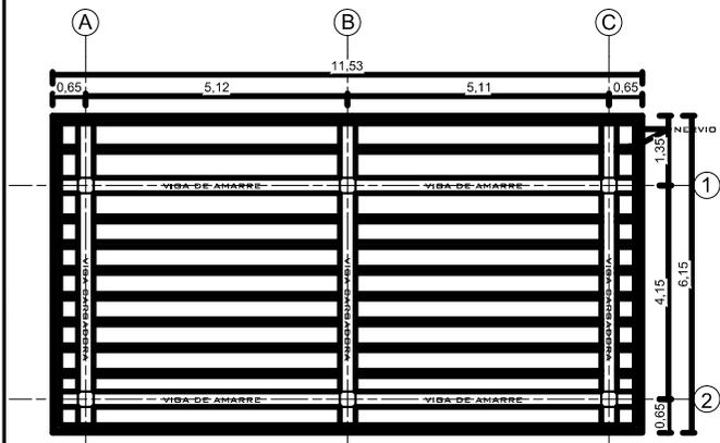
ARMADO DE LOSA TIPO N+3.00
